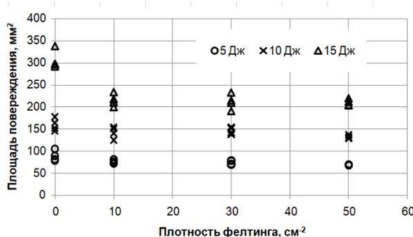
Рисунок 10. Общая площадь повреждения в зависимости от плотности фелтинга
