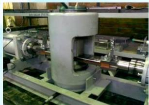
Отечественные опорные части с шаровым сегментом для температур -50°C и ниже имеют критически важное значение для создания дорожной инфраструктуры Арктики, поэтому массовое проектирование подобных изделий нуждается в методах и средствах испытаний для выбора и сертификации антифрикционных полимерных композитов в соответствии с требованиями регуляторов норм в области строительства мостов.
