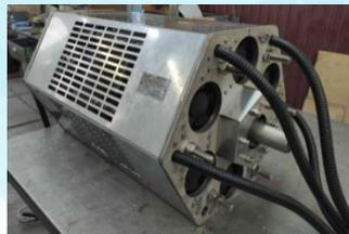
Электромагнитный индукционный корреляционный бесконтактный расходомер для высокотемпературных жидкометаллических теплоносителей
