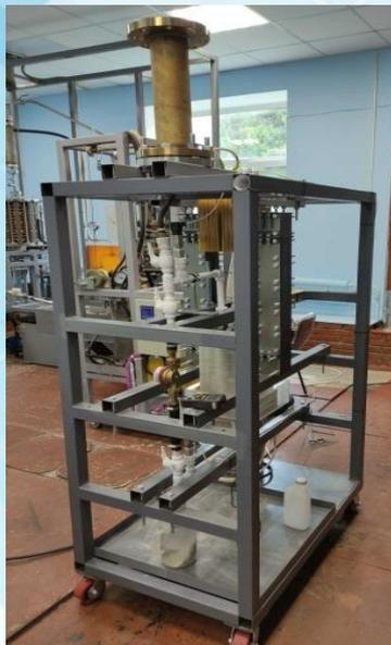
Схема и фото лабораторной модели электромагнитного насоса:
