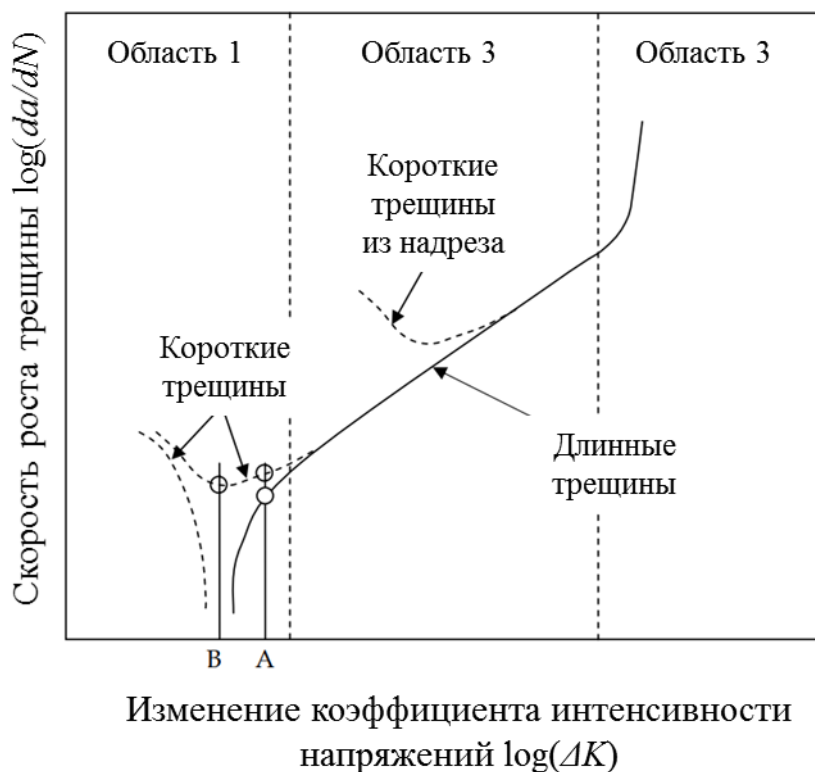
Рис. 1.1.1. Характерная зависимость скорости роста усталостной трещины da/dN от диапазона коэффициента интенсивности напряжений \Delta K при постоянной амплитуде приложенной нагрузки [18].
