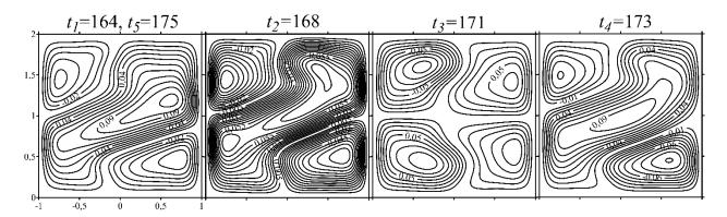
Рис. 3.20 Изолинии функции тока осредненного течения в различные моменты времени (указаны над фрагментами) в течение периода установившихся колебаний для V = 30 и Gr = 0.9
