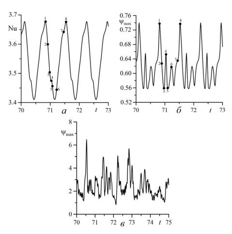
Рис. 4.7 Колебательные режимы при v=25: периодический для Gr=0.7 (a,  $\delta$ ) и квазипериодический для Gr=1.5 ( $\epsilon$ )
