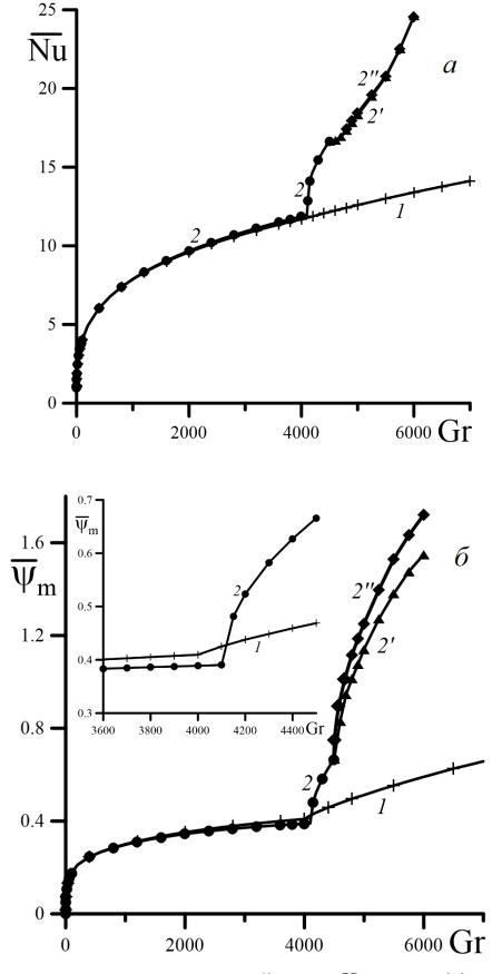
Рис. 3.8 Зависимости средних значений числа Нуссельта (a) и максимума функции тока осредненного течения  $(\delta)$  от числа Грасгофа. Кривая I, соответствует V=0.004, кривые 2, 2' и 2'' построены для V=0.013
