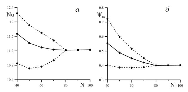
Рис.2.3 Зависимость числа Нуссельта Nu (a) и максимума функции тока  $\psi_{\rm m}(\delta)$  от количества узлов сетки N вдоль оси x для V=0 и Gr=3500
