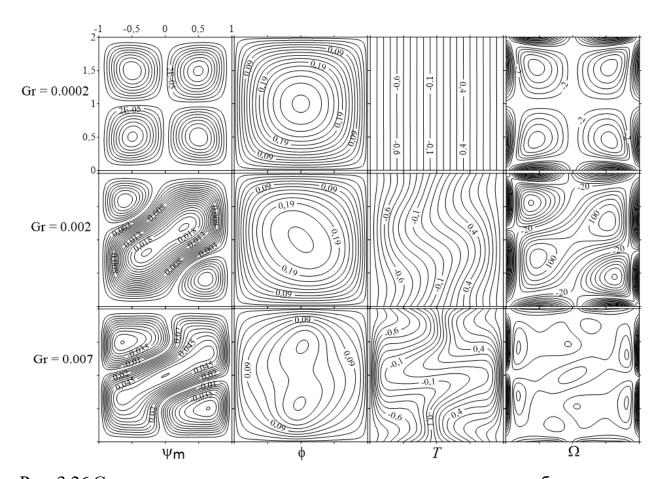
Рис. 3.26 Структура стационарного конвективного течения для вибрационного параметра V=3000: Gr = 0.0002 (область V на рис. 3.1 $\delta$ ); Gr = 0.002 (область II на рис. 3.1 $\delta$ ); Gr = 0.007 (вблизи границы 3 на рис. 3.1 $\delta$ ). Снизу колонок даны обозначения изолиний:  $\psi$  – функции тока осредненного течения;  $\phi$  – функции тока амплитуды пульсационного течения; T – поля температуры;  $\Omega$  – поля завихренности
