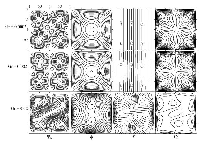
Рис. 3.24 Структура стационарного конвективного течения для вибрационного параметра V=1000: Gr = 0.0002 (область II на рис. 3.16); Gr = 0.002 (область V на рис. 3.16); Gr = 0.02 (вблизи границы 3 на рис. 3.16). Снизу колонок даны обозначения изолиний:  $\psi$  — функции тока осредненного течения;  $\phi$  — функции тока амплитуды пульсационного течения; T — поля температуры;  $\Omega$  — поля завихренности
