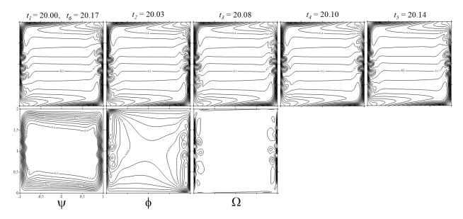
Рис. 3.7 Верхний ряд — изолинии поля температуры нестационарного осредненного конвективного течения для V =0.013 и Gr = 4200 в различные моменты времени. Нижний ряд — изолинии функции  $\psi$ ,  $\phi$ ,  $\Omega$  в указанные сверху моменты времени
