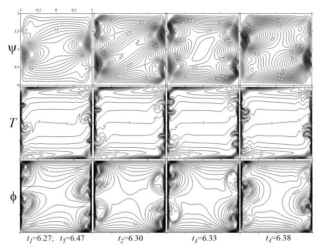
Рис. 3.11 Изолинии осредненной функции тока (верхний ряд), поля температуры (средний ряд) и функции тока амплитуды пульсационного течения (нижний ряд) для развитого осредненного колебательного течения, соответствующего кривой 2' на рисунке 3.8 для V=0.013 и Gr=5500. Изолинии построены для точек I-5 рисунка 3.10~a
