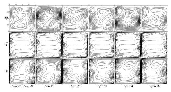
Рис. 3.12 Изолинии осредненной функции тока (верхний ряд), поля температуры (средний ряд) и функции тока амплитуды пульсационного течения (нижний ряд) для развитого осредненного колебательного течения, соответствующего кривой 2'' на рисунке 3.8 для V=0.013 и Gr=5500. Изолинии построены для точек I-7 рисунка 3.10  $\delta$
