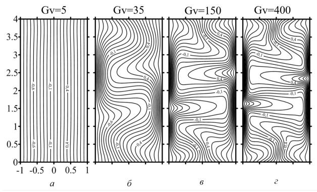
Рис. 5.4 Изолинии температуры, реализующиеся при различных значениях вибрационного числа Грасгофа Gv для v = 100
