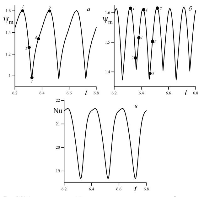
Рис. 3.10 Зависимости  $\psi_{\rm m}$  и Nu от времени для осредненных колебательных режимов при V =0.013 и Gr = 5500: (a) и ( $\delta$ ) – соответствуют кривым 2' (нижняя мода) и 2'' (верхняя мода) на рис. 3.8  $\delta$ , а ( $\epsilon$ ) – соответствует кривым 2' и 2'' рис. 3.8 a
