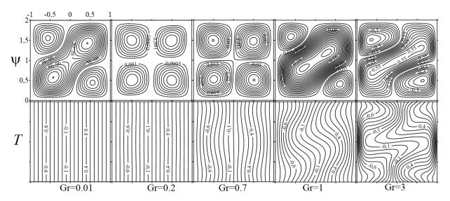
Рис. 4.10 Изолинии осредненной функции тока (первый ряд) и поля температуры (второй ряд) для неньютоновской моды при  $\nu$ =25
