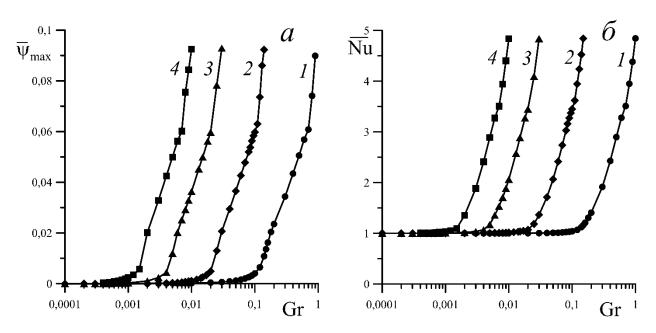
Рис. 3.18 Зависимости средних значений максимума функции тока (a) и числа Нуссельта ( $\delta$ ) осредненного течения от числа Грасгофа для V=30 (кривая I), V = 200 (2), V = 1000 (3) и V = 3000 (4)
