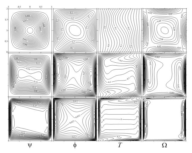
Рис. 3.3 Структуры стационарного течения в области I для вибрационного параметра V=0.013: Gr = 1 — верхний ряд; Gr = 100 — средний ряд; Gr = 4000 — нижний ряд. Снизу колонок даны обозначения изолиний:  $\psi$  — функции тока осредненного течения;  $\phi$  — функции тока амплитуды пульсационного течения; T — поля температуры;  $\Omega$  — поля завихренности
