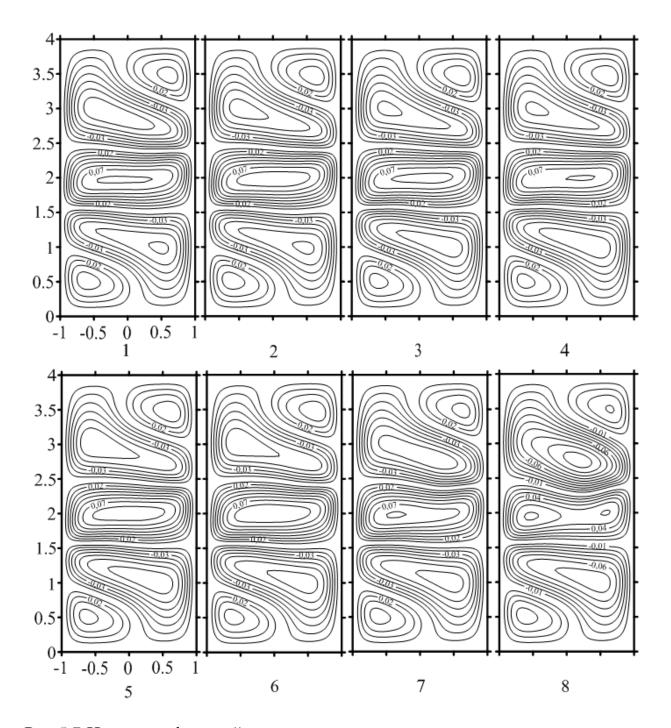
Рис.5.7 Изолинии функций тока осредненного течения в характерных точках периода при  $\mathrm{Gv}=210$  и  $\mathrm{v}=25$ .
