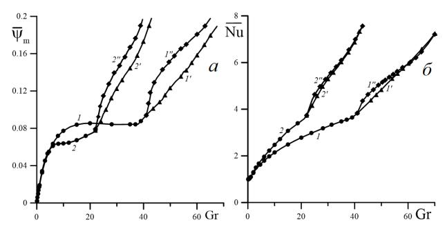
Рис. 3.14 Зависимость средних значений максимума функции тока осредненного течения (a) и числа Нуссельта ( $\delta$ ) от числа Грасгофа: кривые 1, 1′ и 1″ соответствуют V=0.5; 2, 2′ и 2″ построены для V=1.0
