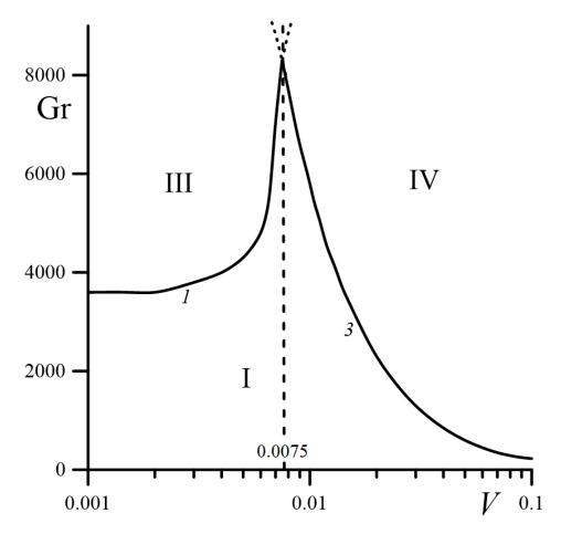
Рис. 3.2 Области существования различных режимов конвективных течений и их границы в диапазоне V < 0.1: І — одновихревое стационарное; ІІ — трехвихревое стационарное; ІІІ — колебательное, обусловленное гравитационным механизмом; IV — колебательное, обусловленное вибрационным механизмом
