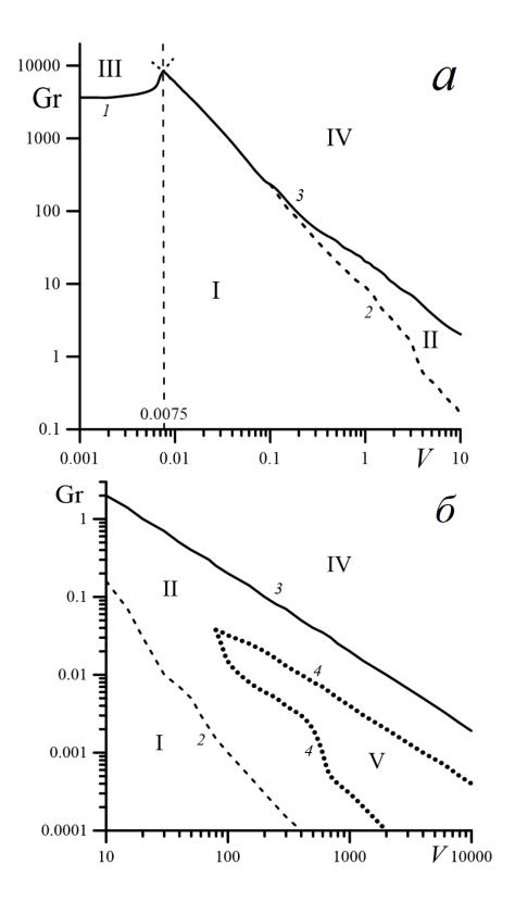
Рис. 3.1 Области существования различных режимов конвекции и их границы: I- одновихревой стационарный; II- трехвихревой стационарный; II- колебательный, обусловленный гравитационной модой; IV- колебательный, обусловленный вибрационной модой; V- четырехвихревой термовибрационный стационарный.
