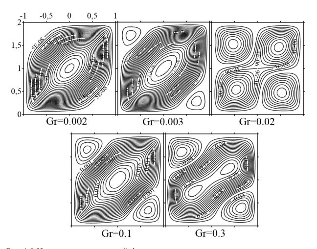
Рис.4.5 Изолинии осредненной функции тока для параметра неньютоновости v=100 в случае ньютоновской моды при различных значениях числа Gr
