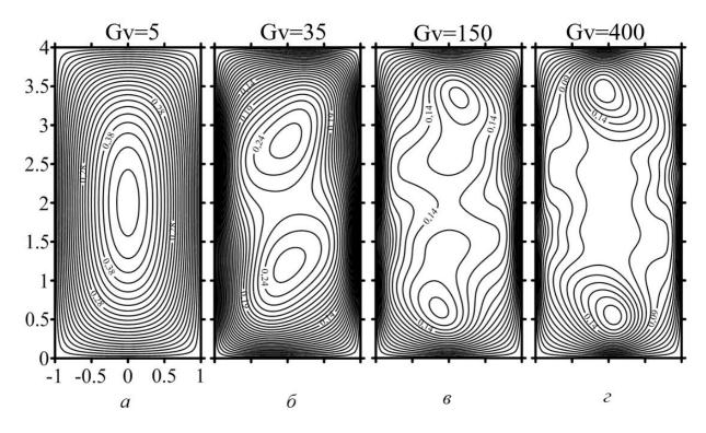
Рис. 5.5 Характерные структуры пульсационного стационарного течения, реализующиеся при различных значениях вибрационного числа Грасгофа GV для  $\nu = 100$
