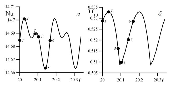
Рис. 3.6 Зависимость числа Нуссельта (a) и максимума функции тока осредненного течения  $(\delta)$  от времени при установившихся периодических колебаниях для V =0.013 и Gr = 4200. Период колебаний равен 0.17 единицы безразмерного времени
