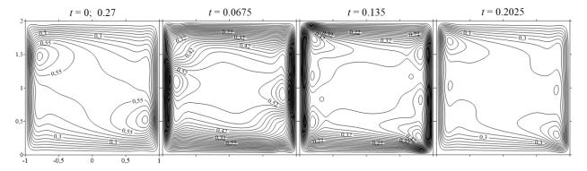
Рис. 3.9 Изолинии функции тока осредненного колебательного течения для V = 0.004 и Gr = 6000 в различные моменты периода колебаний
