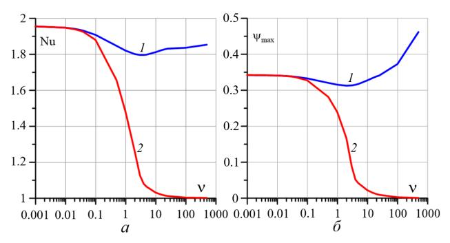
Рис. 4.3 Зависимость числа Нуссельта Nu (a) и максимума функции тока осредненного течения  $\psi_{\max}$   $(\delta)$  от параметра неньютоновости  $\nu$  для ньютоновской (1) и неньютоновской моды (2) для числа Грасгофа Gr=0.3 и вибрационного параметра V=100
