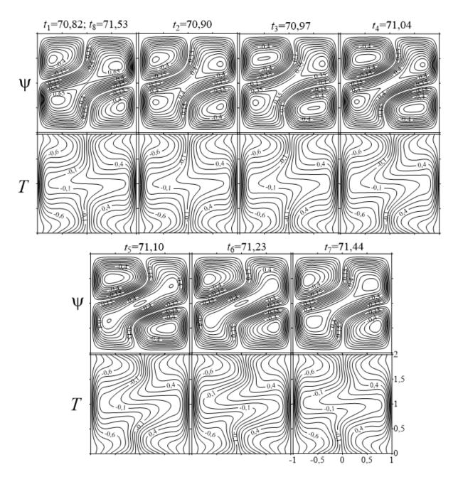
Рис. 4.8 Изолинии функции тока (верхний ряд) и поля температуры (нижний ряд) осредненного колебательного течения для Gr=0.7 и  $\nu=25$  в различные моменты периода колебаний
