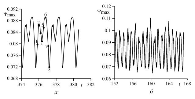
Рис. 5.6 Изменение максимума функции тока осредненного течения в зависимости от времени для Gv = 210 в случае периодических колебаний – v = 25 (*a*) и квазипериодических колебаний – v = 100 (*б*)
