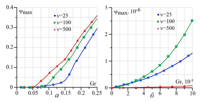
Рис.4.2 Зависимость максимума функции тока от числа Грасгофа для ньютоновской моды псевдопластической жидкости при различных параметрах неньютоновости для  $0 \le Gr \le 0.25$
