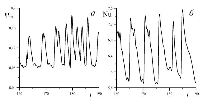
Рис. 3.23 Зависимости максимума функции тока (a) и числа Нуссельта ( $\delta$ ) от времени для нерегулярного колебательного режима при V=200 и Gr=0.2
