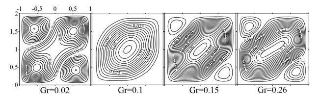
Рис. 4.6 Изолинии осредненной функции тока для параметра неньютоновости v=500 в случае ньютоновской моды при различных значениях числа Gr
