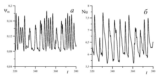
Рис. 3.25 Зависимости максимума функции тока (a) и числа Нуссельта ( $\delta$ ) от времени для нерегулярных колебаний при V = 1000 и Gr = 0.04
