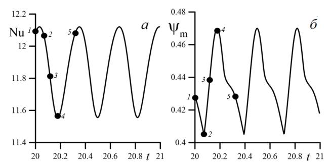
Рис. 3.5 Зависимость числа Нуссельта (a) и максимума функции тока ( $\delta$ ) от времени для установившихся периодических колебаний при V =0.004 и Gr = 4200. Период колебаний равен 0.32 единицы безразмерного времени
