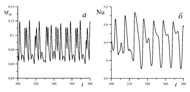
Рис. 3.27 Зависимость максимума функции тока (a) и числа Нуссельта  $(\delta)$  от времени для нерегулярных колебаний при V = 3000 и Gr = 0.009
