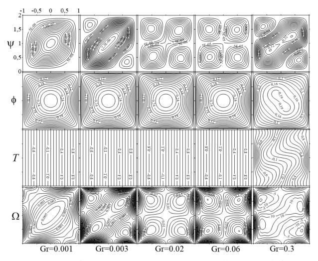
Рис. 4.4 Изолинии функции тока осредненного течения (первый ряд), функции тока амплитуды пульсационного течения (второй ряд), поля температуры (третий ряд) и завихренности осредненного течения (четвертый ряд) для параметра неньютоновости v=25 в случае ньютоновской моды при различных значениях числа Gr
