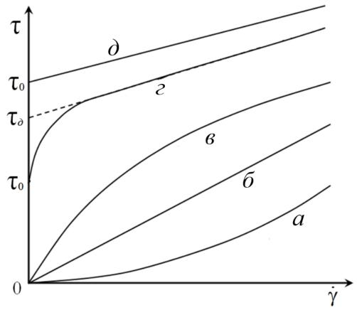
Рис. 2.1 Реологические кривые течения для различных типов обобщенных ньютоновских жидкостей: a — дилатантная жидкость;  $\delta$  — ньютоновская жидкость;  $\epsilon$  — псевдопластическая жидкость;  $\epsilon$  — нелинейно-вязкопластическая жидкость с предельным напряжением сдвига;  $\delta$  — линейно-вязкопластическая жидкость Бингама (Шведова-Бингама).
