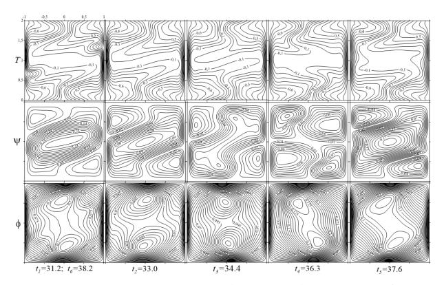
Рис. 3.16 Изолинии поля температуры (верхний ряд), осредненной функции тока (средний ряд) и функции тока амплитуды пульсационного течения (нижний ряд) в течение периода колебаний развитого осредненного колебательного течения, соответствующего кривым 2' на рис. 3.14, V = 1.0 и Gr = 33. Изолинии построены для точек I - 6 верхнего ряда рис. 3.15
