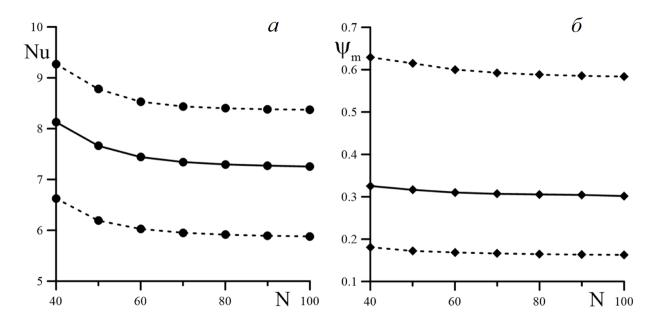
Рис. 2.4 Зависимости Nu (a) и  $\psi_{\rm m}$   $(\vec{o})$  от количества узлов сетки N вдоль оси x для V=0.1 и Gr=300
