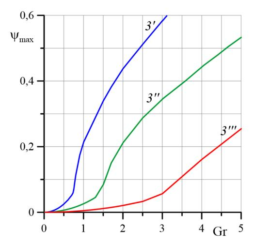
Рис. 4.9. Зависимость максимума функции тока  $\psi_{\text{max}}$  от числа Грасгофа Gr для неньютоновской моды при различных значениях параметра неньютоновости: 3' - v = 25, 3'' - v = 100 и 3''' - v = 500
