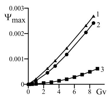
Рис. 5.2 Зависимость максимума функции тока  $\psi_{max}$  от вибрационного числа Грасгофа Gv при различных параметрах неньютоновости: 1 - v = 25, 2 - v = 100, 3 - v = 500
