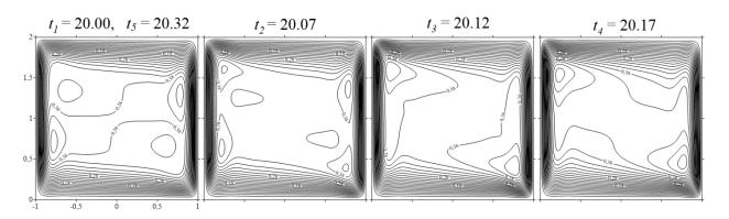
Рис. 3.4 Изолинии функции тока осредненного течения в различные моменты времени в течение периода установившихся колебаний для V=0.004 и Gr=4200 в случае гравитационного механизма неустойчивости
