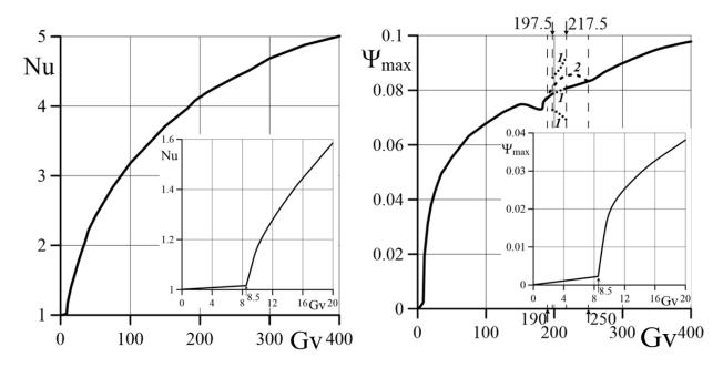
Рис. 5.1 Зависимость числа Нуссельта Nu (a) и максимума функции тока  $\psi_{\text{max}}$   $(\delta)$  от вибрационного числа Грасгофа Gv при  $\nu = 25$  и  $\nu = 100$
