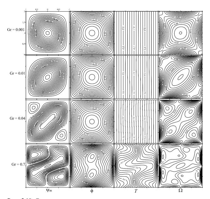
Рис. 3.19 Структура стационарного осредненного течения жидкости для вибрационного параметра V=30: Gr = 0.001 (область I на рис. 3.1 $\delta$ ); Gr =0.01 (вблизи границы I на рис. 3.1 $\delta$ ); Gr = 0.04 (область II на рис. 3.1 $\delta$ ); Gr = 0.7 (вблизи границы I на рис. 3.1I). Снизу колонок даны обозначения изолиний: I — функции тока осредненного течения; I — функции тока амплитуды пульсационного течения; I — поля температуры; I — поля завихренности
