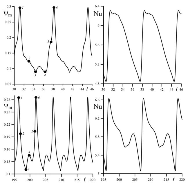
Рис. 3.15 Зависимости Nu и  $\psi_{\rm m}$  от времени для различных колебательных режимов осредненной конвекции при V=1.0 и Gr = 33. Верхний ряд — симметричная колебательная мода (кривые 2' на рис. 3.14) с периодом 7.0; нижний ряд — несимметричная колебательная мода (кривые 2'' на рис. 3.14) с периодом 11.0.
