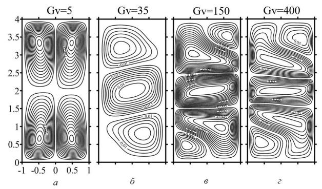
Рис. 5.3 Характерные структуры осредненного стационарного течения для полей функции тока, реализующиеся при различных значениях вибрационного числа Грасгофа Gv для  $\nu=100$
