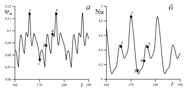
Рис. 3.21 Зависимости максимума функции тока (a) и числа Нуссельта ( $\delta$ ) от времени для установившихся периодических колебаний при V = 30 и Gr = 0.9
