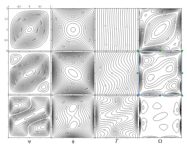
Рис. 3.13 Структуры вибрационно-конвективных течений для V=10: верхний ряд — Gr=0.1 (область I); средний ряд — Gr=0.5 (область II); нижний ряд — Gr=2 (граница областей II и IV). Снизу колонок даны обозначения изолиний:  $\psi$  — функции тока осредненного течения;  $\phi$  — функции тока амплитуды пульсационного течения; T — поля температуры;  $\Omega$  — поля завихренности
