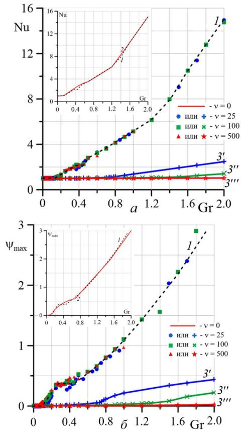
Рис. 4.1 Зависимости числа Нуссельта Nu (a) и максимума функции тока  $\psi_{\text{max}}$   $(\delta)$  от числа Грасгофа Gr: 1 – псевдопластическая жидкость, ньютоновская мода; 2 – ньютоновская жидкость,  $\nu=0$ ; 3', 3'', 3''', 3''' – псевдопластическая жидкость, неньютоновская мода
