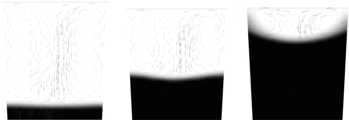
Рис. 3.28. Эволюция границы раздела фаз при кристаллизации алюминиевого слитка в бегущем вверх магнитном поле ( $I = 3$  А,  $B = 4$  мТл,  $f = 50$  Гц); слева – начало процесса
