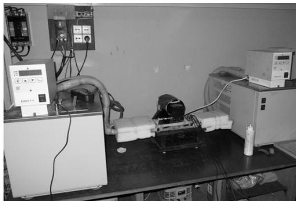
Рис. 3.7. (а) – схема экспериментальной установки: 1 – ячейка, 2 – медные теплообменники, 3 – УДА датчики, 4 – термостаты, 5 – источник питания переменного тока, 6 – С-образный индуктор; (б) – фотография экспериментальной установки
