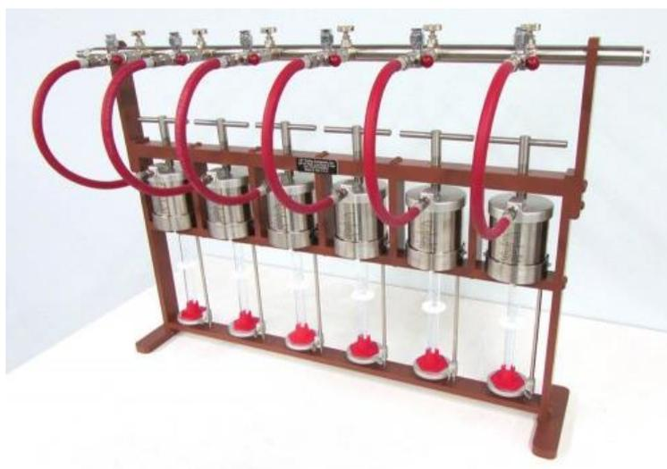
Рисунок 2.8 – Шестиячеечный фильтр-пресс LTLP, Модель 12BL-6
