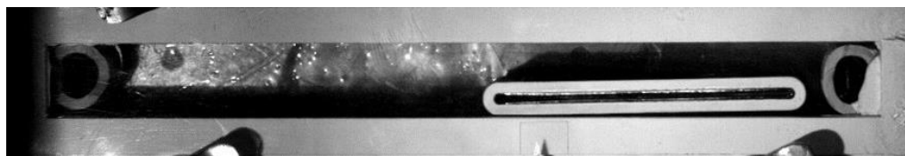
Рис. 1.31. Крайние положения полости при вибрациях, b = 32.6 мм, f = 10.5 Гц
