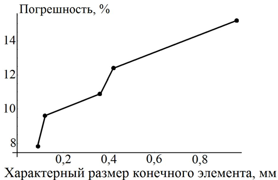
Рисунок 3.8 – График сходимости сдвиговой компоненты тензора напряжений
