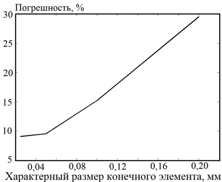
Рисунок 3.33 – График сходимости интенсивности тензора деформаций
