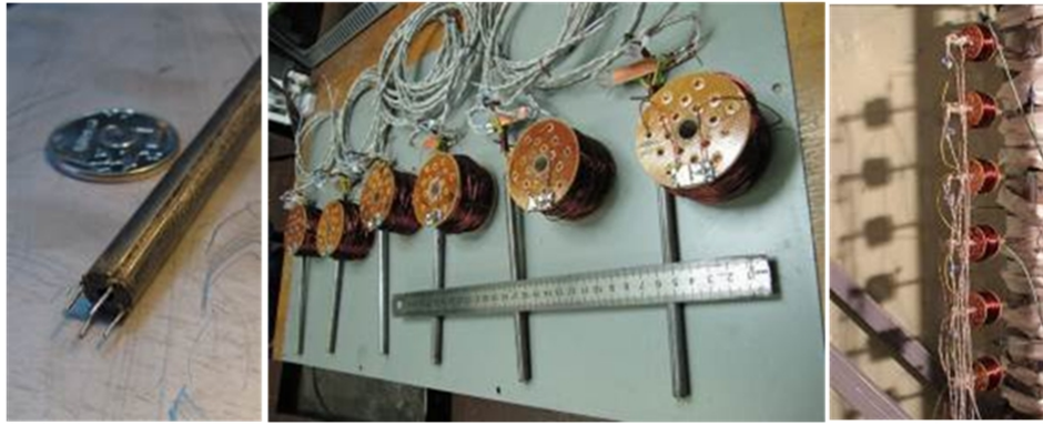
Рис. 2.17. Фотографии модифицированных кондукционных датчиков скорости.
