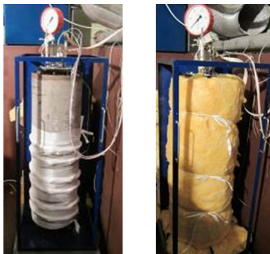
Рис. 2.1. Система хранения натрия: слева – без теплоизоляции, справа – с теплоизоляцией.
